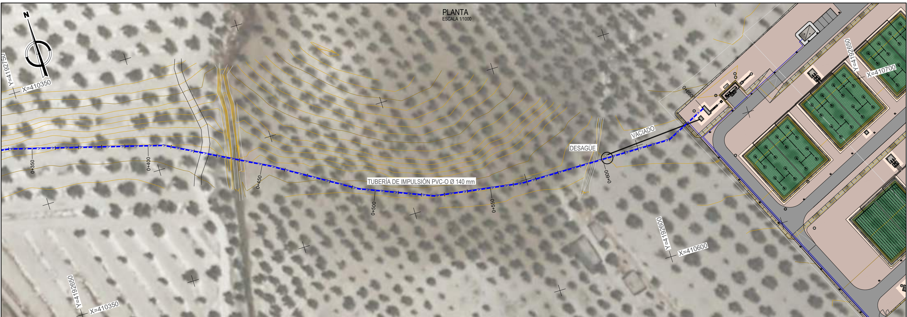
TUBERÍA DE IMPULSIÓN PVC-O Ø 140 mm ESCALA H=1/1000 V=1/200
